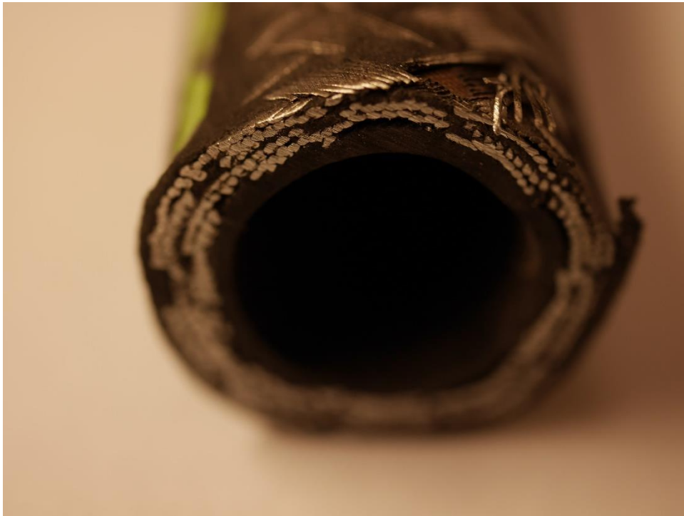
Figur 106. Slang med innerdiameter 1/2". Två lager stålkord krysspunnet. The two layer steel cord of the ID 1/2" tube.
