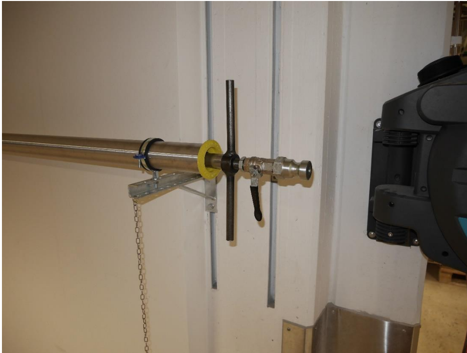
Figur 31. Borrhålssimulatorn bestående av 2 st 6 m långa rostfria rör med diametern 63.5 mm med instucket och med handtaget fastspänt injekteringsrör. Injection tube installed in the drill hole simulator using a packer.
