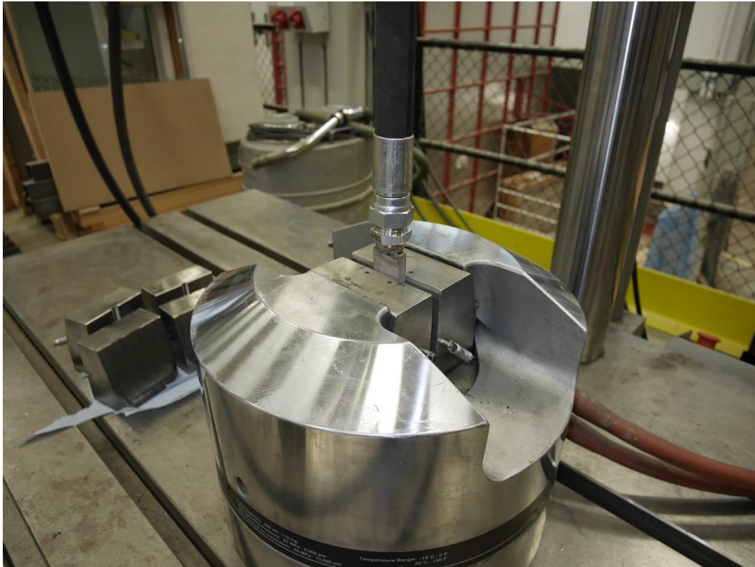
Figur 104. Enkelt dragtest av slang med ID 3/4". Fäste för draganordningen passar i slangkopplingens 1/2" gänga.
