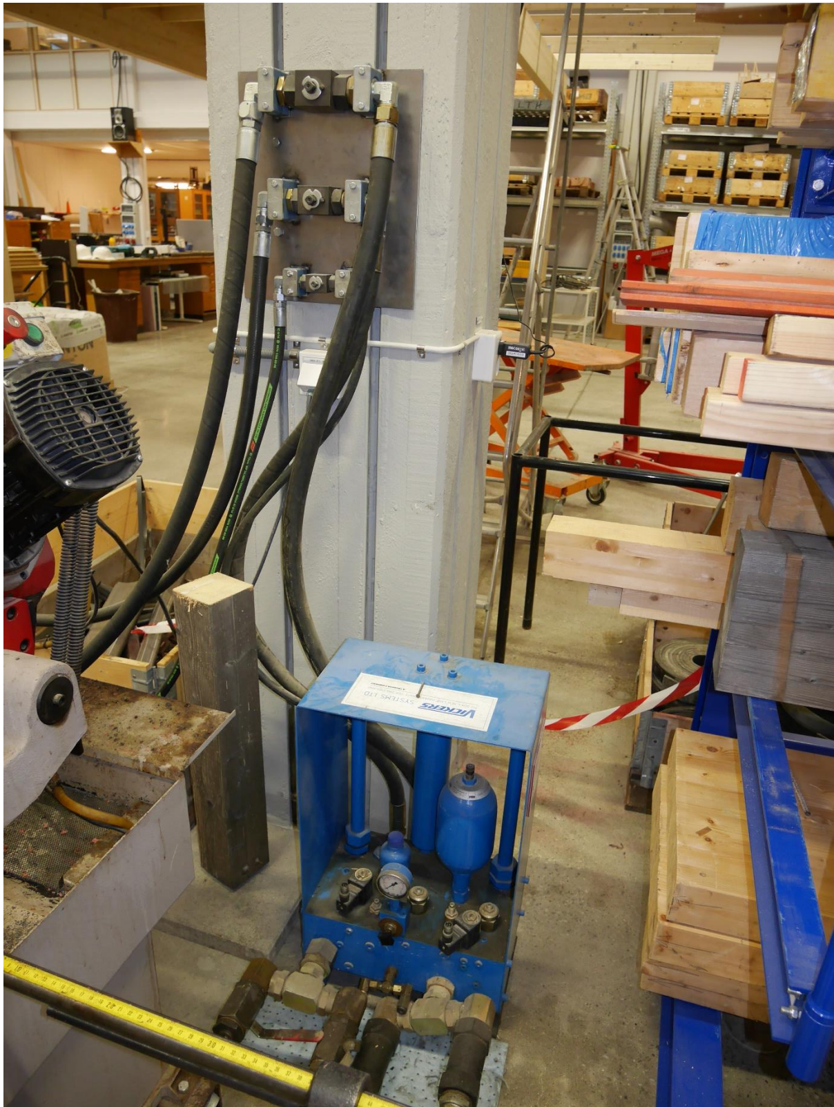
Figur 5. En uttagsstation till hydraulpumpen. Levererar 220 bar och 90 l/min.
