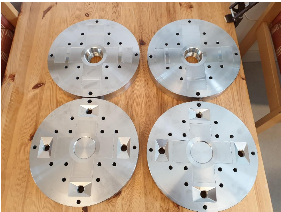
Figur 34. Nyttillverkade varianter av "kort spalt" med följande spaltvidder: Spalt 1: 40, 55, 70 och 95 \mu\text{m} - Spalt 2: 80, 100, 120 och 140 \mu\text{m} . Design Almir Draganovic, KTH Jord och Bergmekanik. Short columns with eight apertures.
