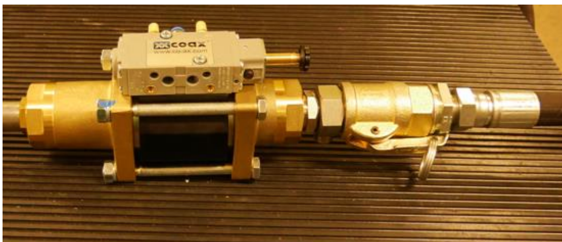
Figur 3. Elektropneumatiskt styrd koaxialventil för experiment med tryckslag. An electropneumatic coaxial valve used for water hammer experiments.
