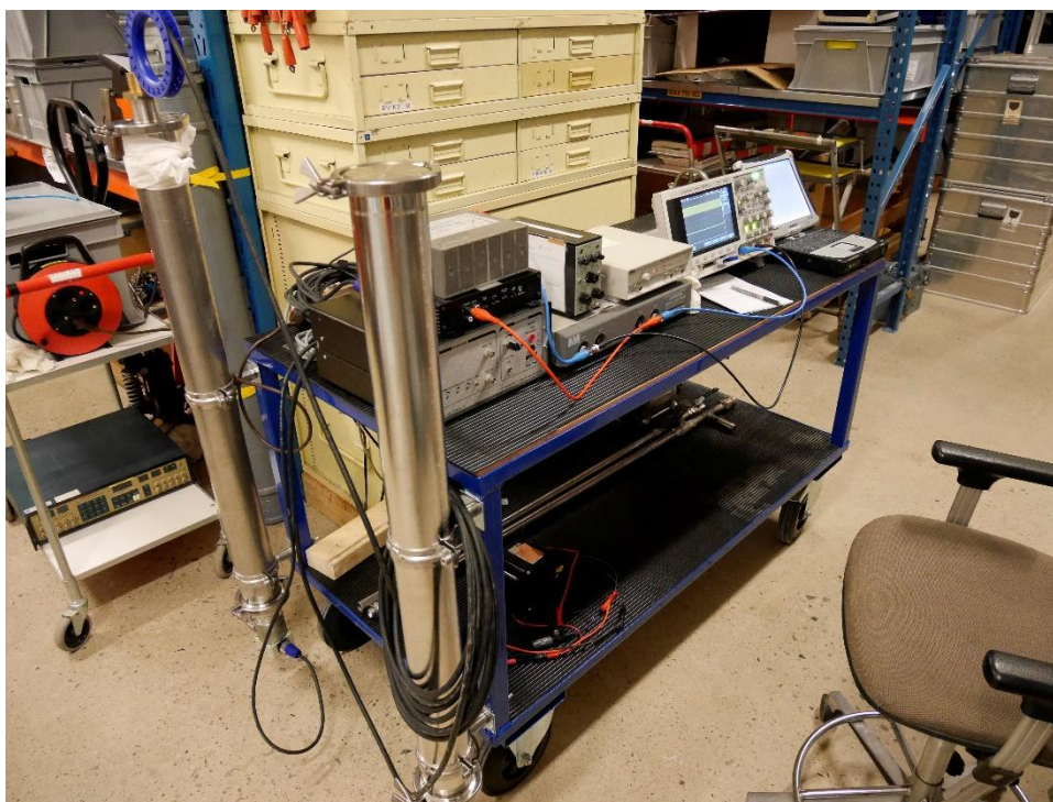
Figur 2. Resonanskamrarna uppkopplade med olika sändare i nedre delen. Det borte röret har en hydrofon som återkopplar svängningarna i röret, vilket gör att den dominerande tonen tar över. Denna hydrofon flyttas mellan rören. Equipment for feedback resonance experiments.
