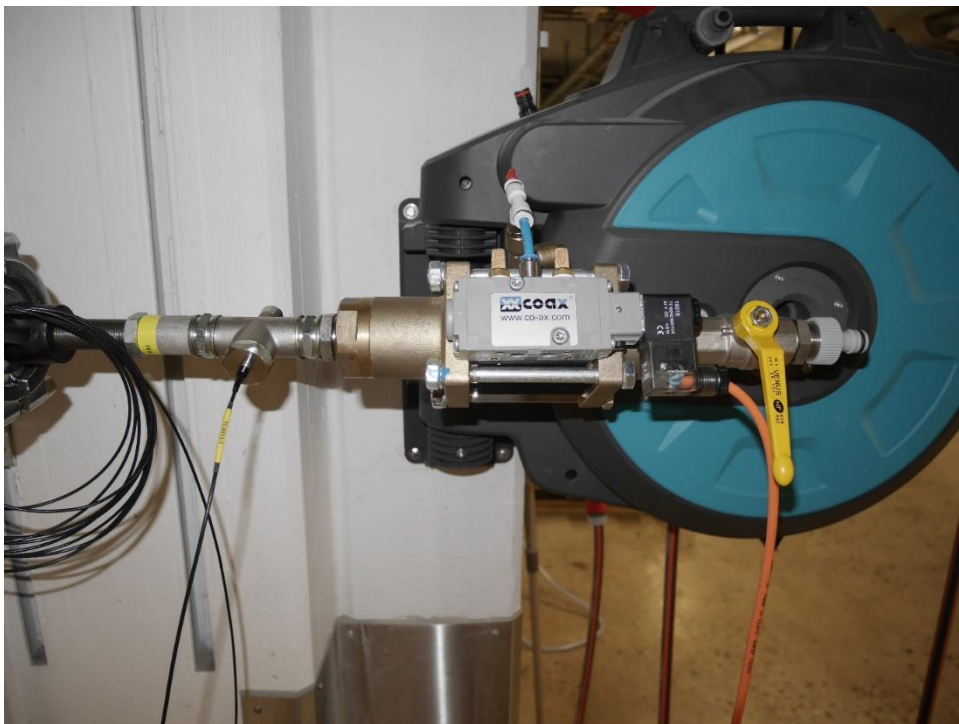
Figur 32. Elektropneumatiskt styrd koaxialventil för generering av tryckslag. Den är kopplad direkt till ett injekteringsrör inskjutet i det rostfria röret, tätat med en konventionell expander, sk "packer". The coaxial valve mounted on the injection tube.
