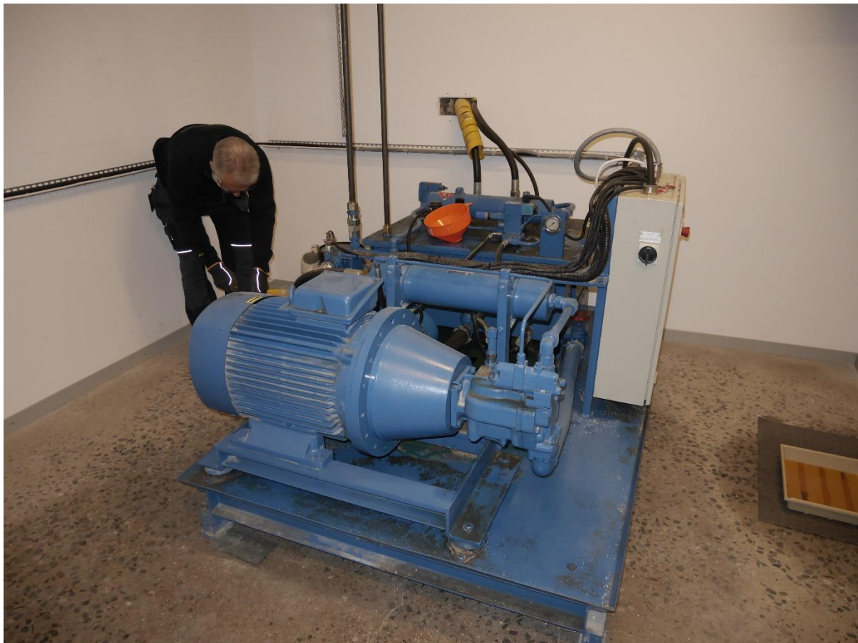
Figur 4. LTH:s största hydraulpump 220 bar och 90 l/min.
