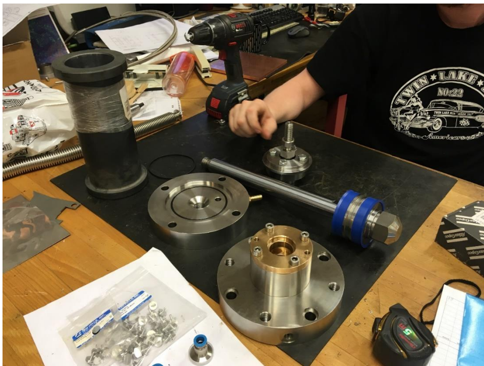
Figur 21. På bordet brukcylinder, gavlar, klämkoppling mellan hydraulcylinderns kraftgivare och brukpumpens kolvstång samt kolv med kolvstång. The parts manufactured at LTH.
