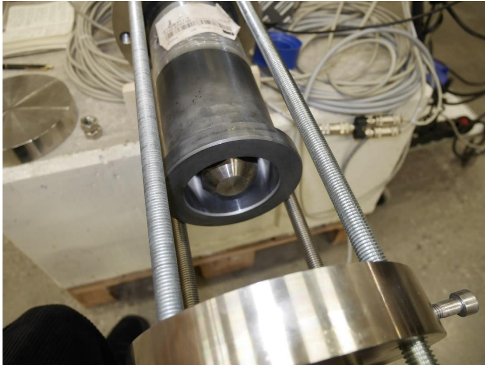
Figur 26. Kolvens framdel utgörs av en stor mutter som syns inuti cylinderns framdel. The piston installed in the grouting cylinder.
